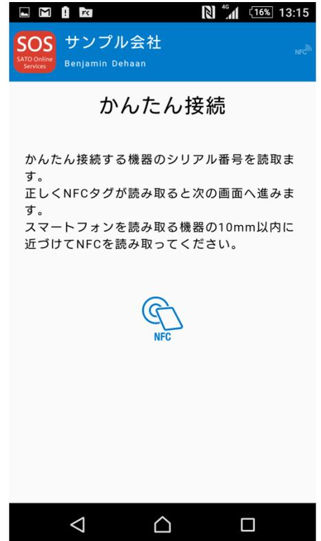
かんたん接続画面を表示した状態でプリンタの NFC をタッチします。NFC は下図の赤丸部分に搭載されています。
