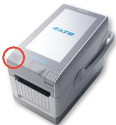
・QR/NFC 接続画面を表示した状態でプリンタの NFC をタッチします。NFC は下図の赤丸部分に搭載されています。
