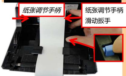
按着纸张调节手柄的滑动扳手，使纸张调节手柄左右滑动，根据标签的宽度调整好。
