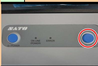
按下FEED/LINE键，纸张会出来一小部分，这时ON LINE (POWER) 灯点亮，打印机处于在线状态。
