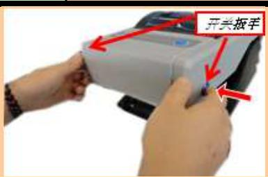
将打印机主体左右的上盖开关扳手向方拉就可以解除上盖的锁定，然后就可
