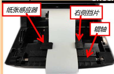
将标签在纸张感应器和右侧挡片的下通过，在比前方的辊轴稍微多一点设置好。
