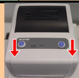
关闭打印机上盖。向下按压键头部分，听到‘咔’的一声，打印机关闭好。
