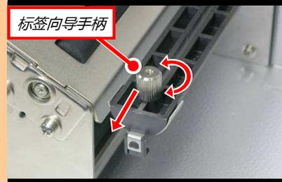
如图所示向左旋转松开标签向导把手，滑向最外侧。
