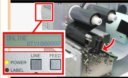
如图所示向左下方旋转关闭打印头杠杆，关闭打印头。按 FEED 键，标签会自动定位，再按 LINE 键进入 ON LINE 状态，准备打印。
