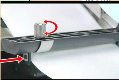
如图所示向左旋转松开标签向导把手后，使底部幅度调整到和标签大小一样，最后向右旋转固定标签向导把手即可。
