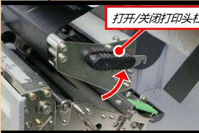
如图所示向右上旋转，打开关闭打印头杠杆。
