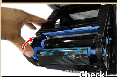
将新碳带在碳带的卷取部的空卷芯上卷好，直到看不到碳带透明的部分并且碳带没有起皱。参照碳带安装图
