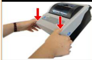
确认标签已经安装好，关上打印机上盖，按压箭头所标的位置，听到‘咔’的一声，打印机正常关闭。
