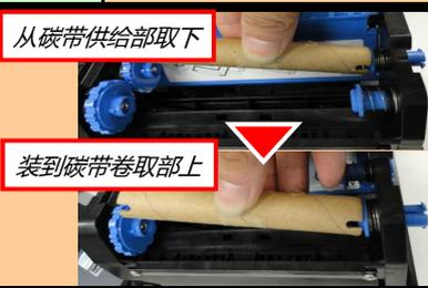
压着碳带供给部的碳带卷芯右侧，取下空卷芯并压着碳带卷取部的右侧安装好空的卷芯。
