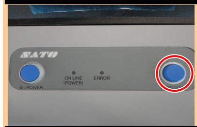
按下FEED/LINE键，纸张会出来一小部分，这时ON LINE (POWER) 灯点亮，打印机处于在线状态。在OFFLINE时，ON LINE (POWER) 灯一直会闪烁。
