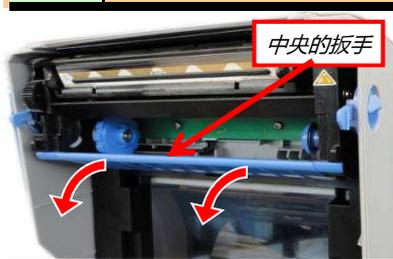
向前拉中央的扳手的左路右端，可以拉出碳带的组件。
