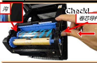
按压着碳带供给部的右侧装好新碳带。将碳带卷取部突起的部分插入碳带卷芯的沟内，按下卷芯导杆。
