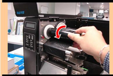
如图所示向左旋转适量碳带卷取部的碳带到没有出褶为止。
