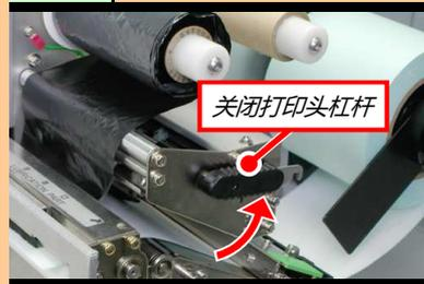
如图所示向右上方旋转打开关闭打印头印头杠杆，开启关闭打印头印头杠杆。
