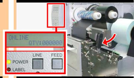
首先确认标签已安装好之后，向左旋转关闭打印头杠杆，关闭打印头。然后按下 FEED 键自动定位，最后再按下 LINE 键链接到 ONLINE 状态，准备打印。
