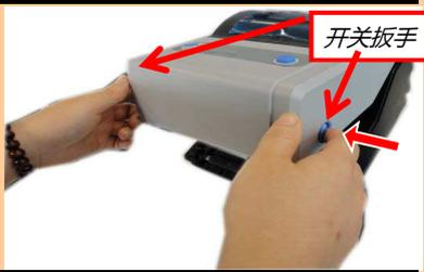
将打印机主体左右的上盖开关扳手向
