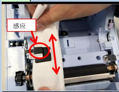
将沾上清洁液的棉布在纸张感应器的下方, 按图示方向来回移动, 擦拭掉污物。
