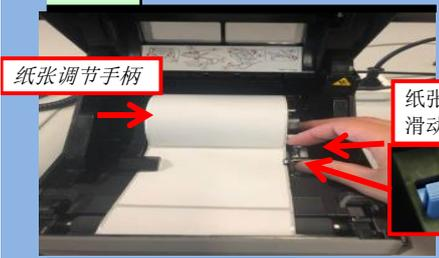
按着纸张调节手柄的滑动扳手，使纸张调节手柄左右滑动，根据标签的宽度调整好。
