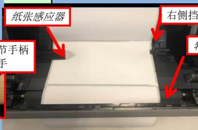
将标签与纸张感应器和右侧挡片下通过，将标签设置在滚轴前方
