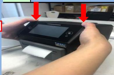
关闭打印机上盖。向下按压键头部分，听到“咔”的一声，打印机关闭好
