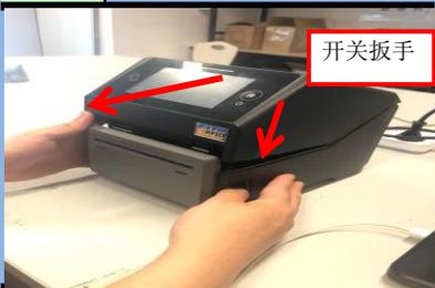
将打印机主体左右的上盖开关扳手向下方拉就可以解除上盖的锁定，然后可以
