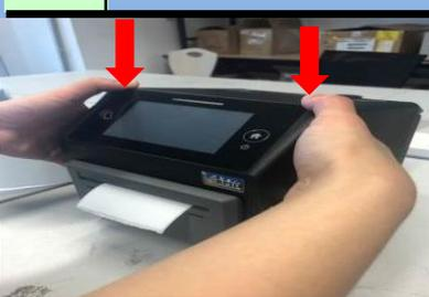
确认标签已经安装好，关上打印机上盖，按压箭头所标的位置，听到‘咔’的一声，打印机正常关闭。
