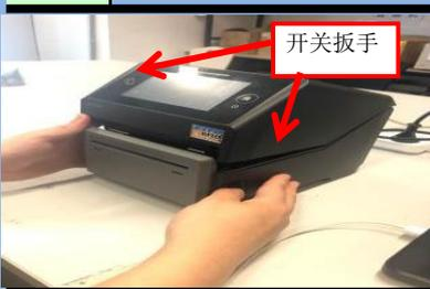
将打印机主体左右的上盖开关扳手向下方拉就可以解除上盖的锁定，然后可以打开
