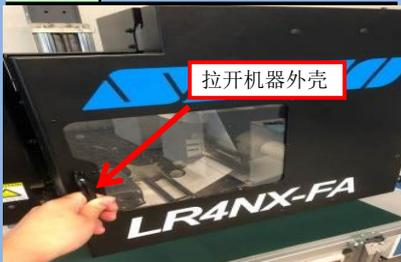
将打印机外壳将外打开。
