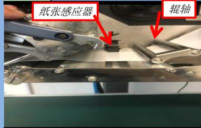
将标签与纸张感应器下通过，参照表前安装路径图
