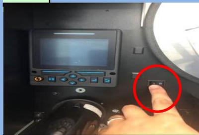
按下开机键，机器内操作显示屏下发按键操作
