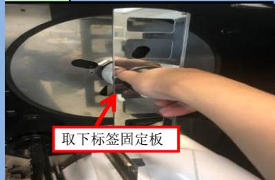
将标签固定板往外拉，取下固定板
