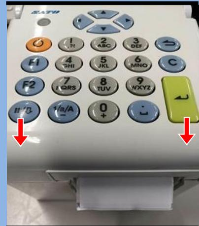
关闭打印机上盖。向下按压键头部分, 听到‘咔’的一声, 打印机关闭好。
