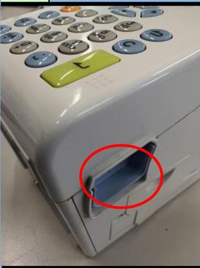
将打印机主体右边的开关向下按, 即可打开外盖
