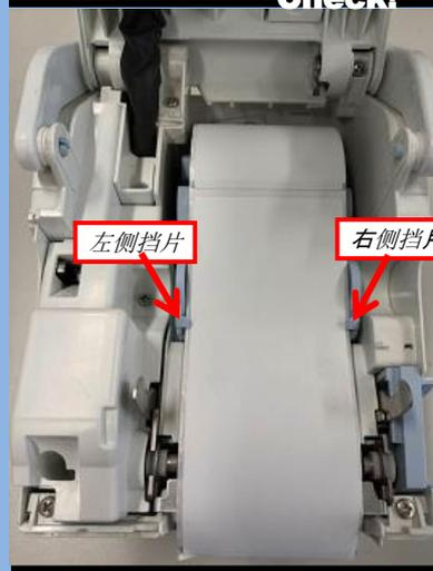
将标签在左侧挡片和右侧挡片的下通过
