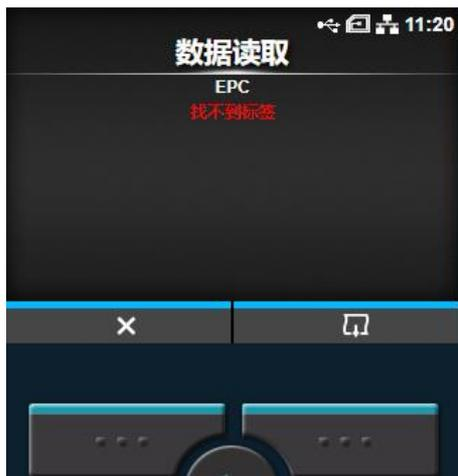
12. 校验参数，RFID参数设置 标签偏移后，再到视图中按长条右键走纸时已代入标签偏移，此时应该是能读到标签芯片内容，多走几次纸确认。若无误，可进行打印测试。
