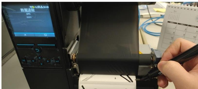
13. 若有偏差不能稳定读取，以出标口撕纸铁片做参考，在标签边做记号①，然后继续寻找最佳读写位置（读写范围的中间点）
