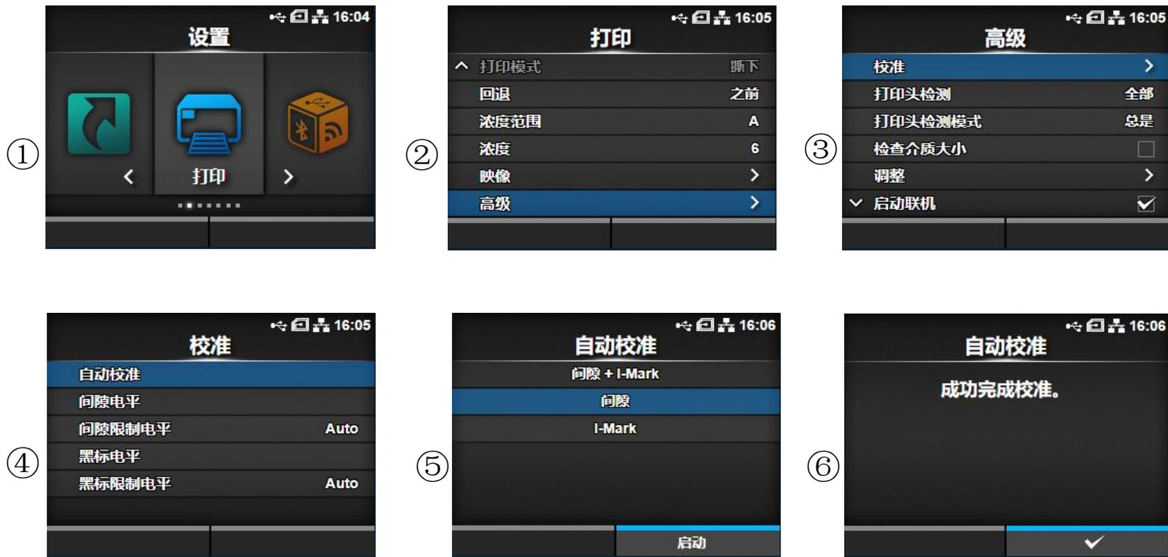
进入菜单-打印-高级-校准-自动校准-间隙 启动自动校准至提示 成功完成校准。
