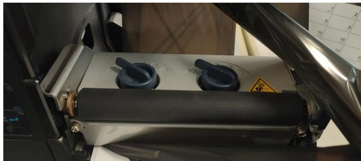
1. 打印头旋钮压力调小，减少后续的手动拖拽带给打印头的磨损。
