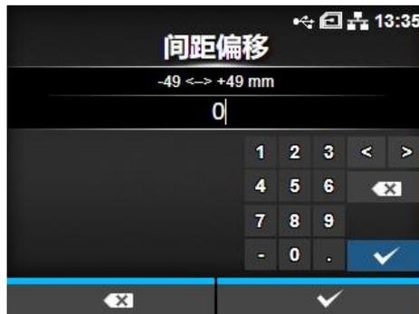
上图由菜单-打印-高级-调整进入，“间距偏移”是调整标签的位置（同时包括印字和停止位置）。比如通常打印机对标签的判定是标签前边是开始位置，若间距偏移设置 +5，则打印机判定标签前边往后 5mm 的地方为标签开始位置，-5 则时往前 5mm。
