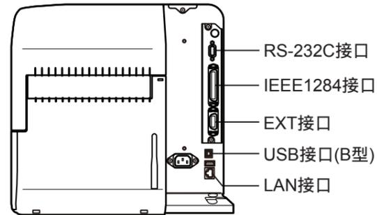
连接打印机通信电缆前,
